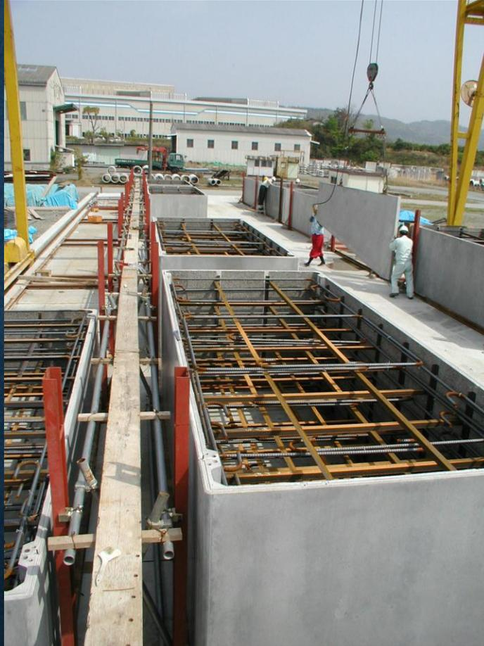
工場での函体の組立状況
