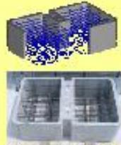
鉄筋、型枠の高所作業なし
