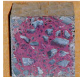
普通コンクリート供試体
